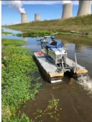
Figure 8 : photographie lors de l'arrachage mécanique des plantes aquatiques dans le canal d'amenée.
