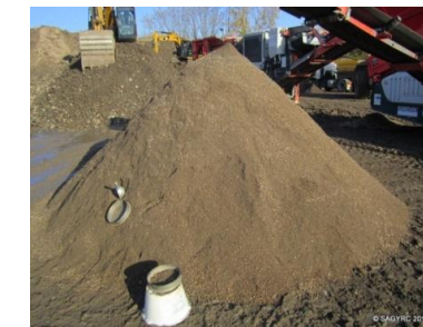
Matériaux sortie crible : fraction 0/20mm dépourvue de rhizomes
