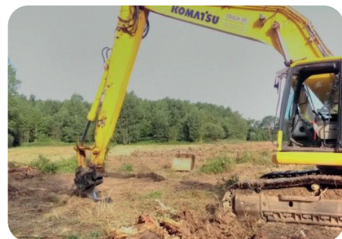
2 Rognage des souches pour lutter contre la reprise du boisement.
